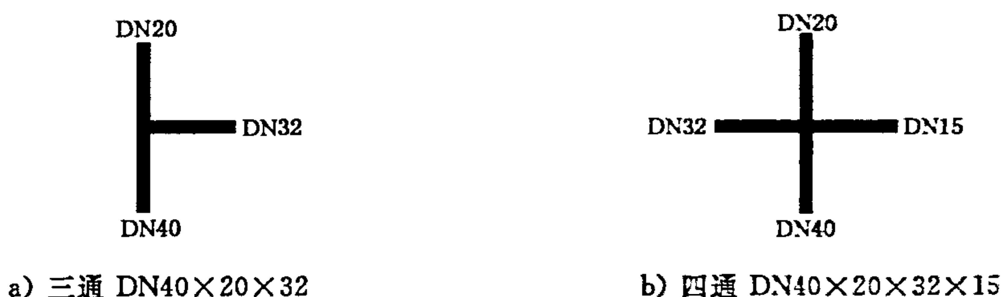
图 8 异径三通和四通公称尺寸的表示方法
